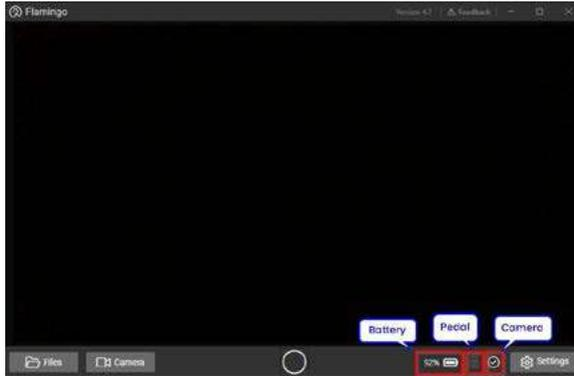
Los iconos de la batería y la cámara indican que sus respectivos hardware están conectados correctamente, mientras que el icono del pedal en gris indica que el pedal no está conectado correctamente.
